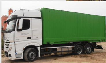
Diese Mobile Dosieranlage - MDA wurde für die regelkonforme Herstellung von Flüssigboden auf Basis von Böden und Baustoffen entwickelt.
